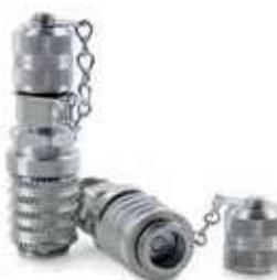
Szybkozłączce diagnostyczne, daje możliwość kontrolowania parametrów oleju w wysokociśnieniowych układach hydraulicznych. Gniazdo zakończone jest złączem minimesowym pod przewód pomiarowy M16x2. Zamienne z szybkozłączami ISO 15171-1 innych producentów.
